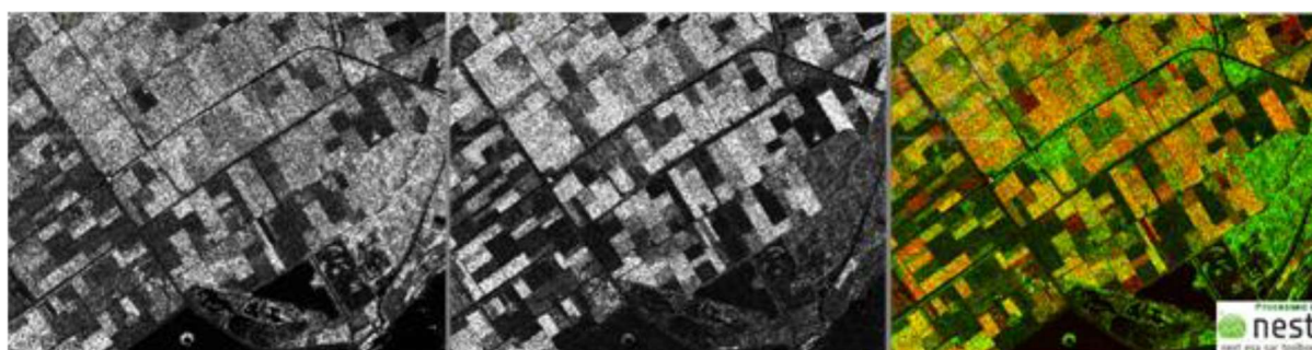
Obr. 4: Intenzity z různých polarizačních kanálů, zdroj: MDA, CSA, ESA
