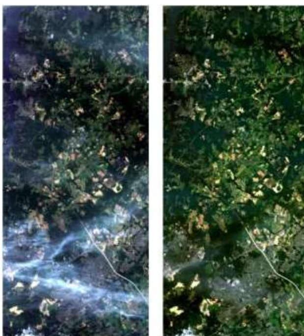
Obr. 12 Data před atmosférickou korekcí (vlevo) a po korekci (vpravo), vytvořený Sentinel 2 toolboxem
