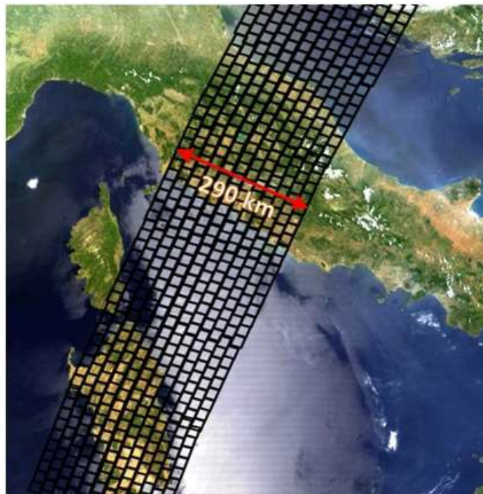
Obr. 10 Typická struktura rozložení granulí v produktu úrovně 1B, zdroj: ESA
